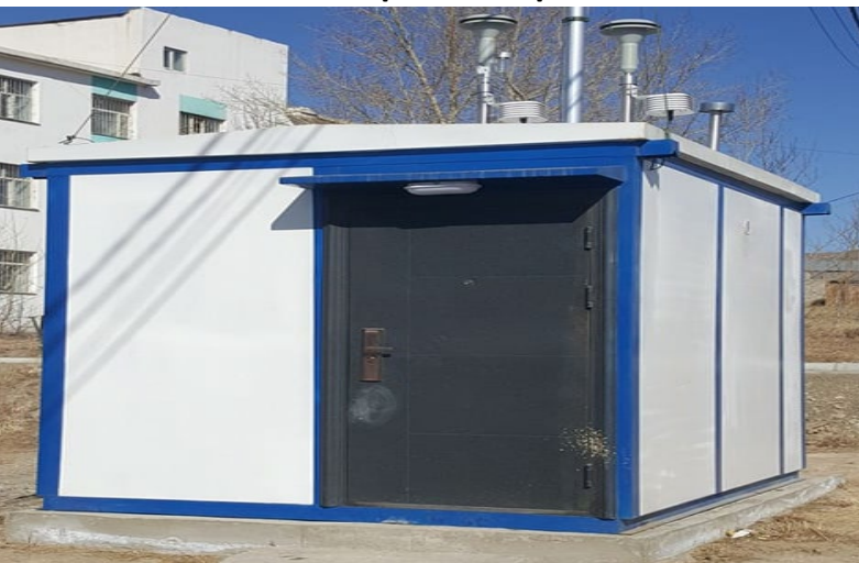
Агаарын чанарын хяналт шинжилгээний автомат харуул
